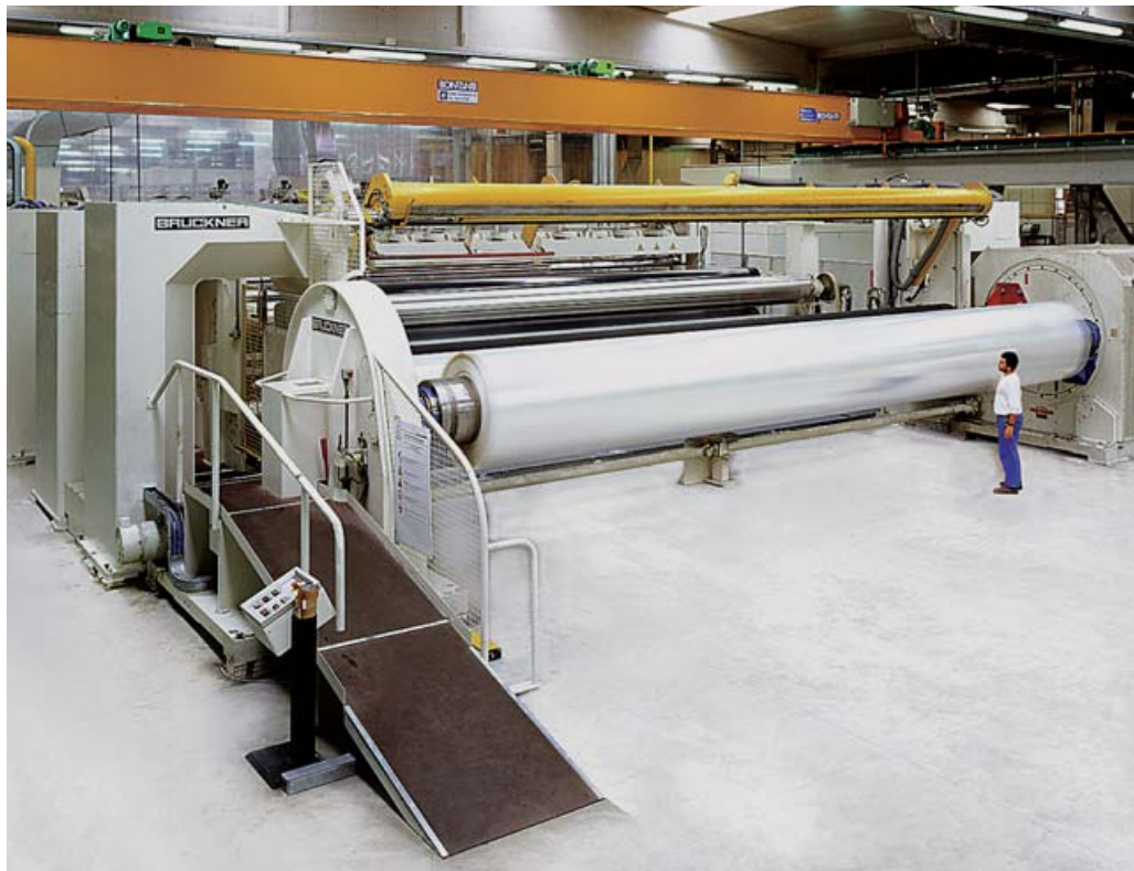
Der Pull Roll verbindet Einheiten zur Oberflächenbehandlung der Folie mit Messern zum Randbeschnitt und Transportwalzen – auf dem Wickler wird das fertige Halbzeug gespeichert.
